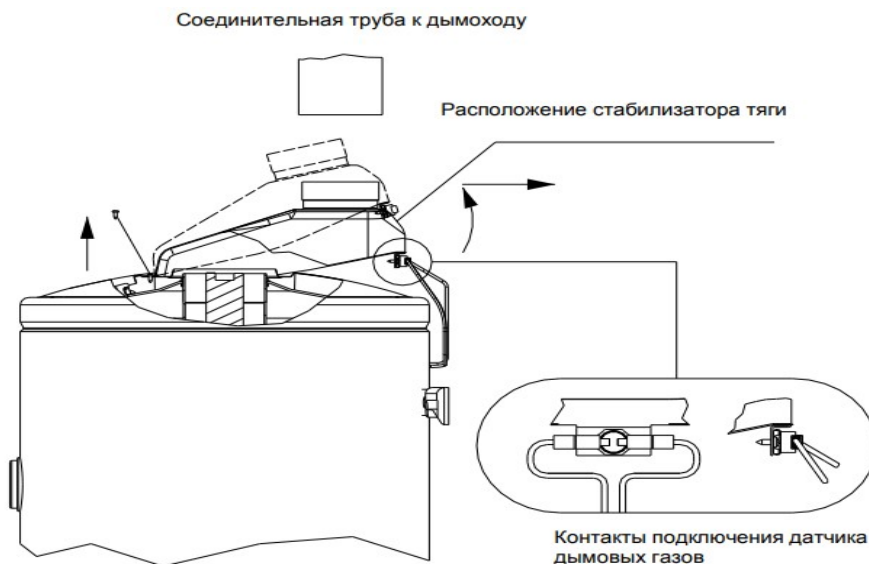
Рис. 14 Подключение датчика дымовых газов
