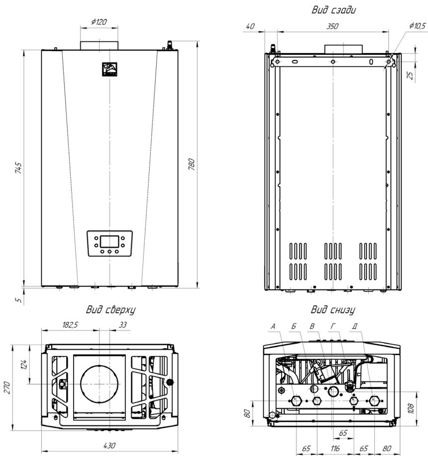
**Рис. 2. Габаритные и присоединительные размеры котлов Prime-MA**
