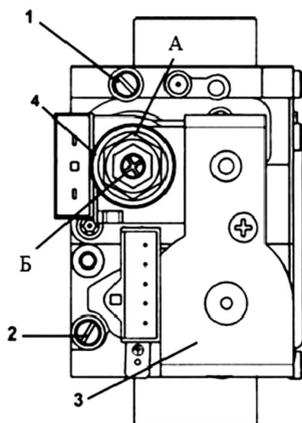
1. Штуцер автоматике безопасности для измерения давления на горелке;
