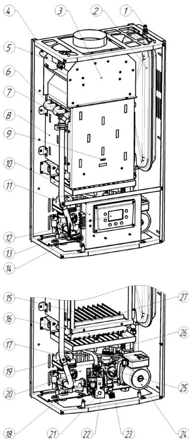
**Рис.1. Конструкция котла**
