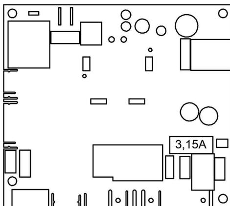
**Рис. 10. Расположение предохранителя**
